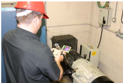
Fig 2. Inspección de un equipo mecánico utilizando una cámara de termografía
