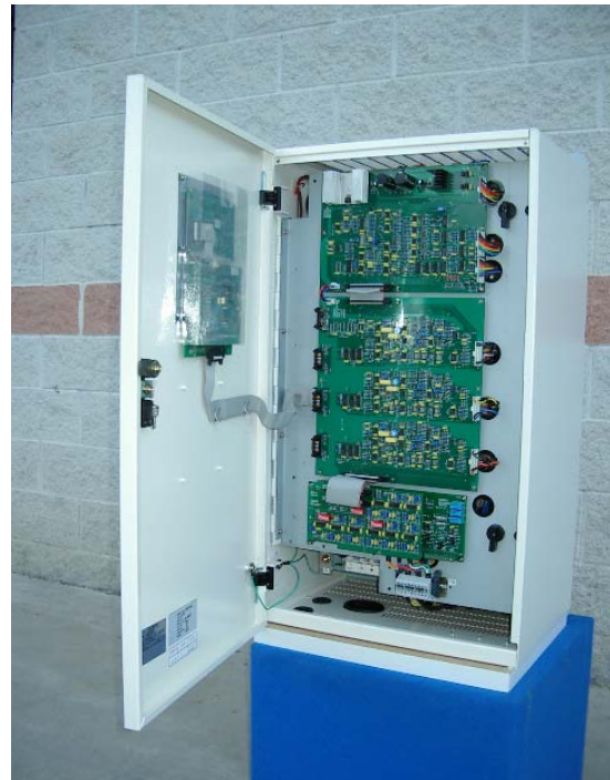
Filtro activo AS34-400/50, 3 fases y 4 hilos, de 50A para red a 400V, 50Hz. Vista exterior e interior.
