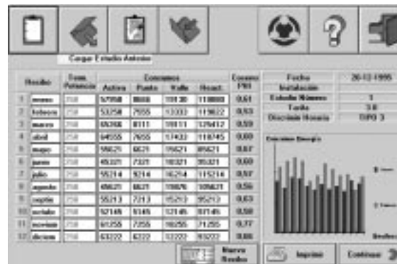
► Fig. 1.4.2-2. Pantalla del programa Cálculo CYDESA , mostrando los datos de consumo de 12 recibos y los relativos a la tarifa contratada. La columna coseno PHI calcula para cada recibo el factor de potencia y haciendo un doble clic con el ratón el recargo Kr en %.
