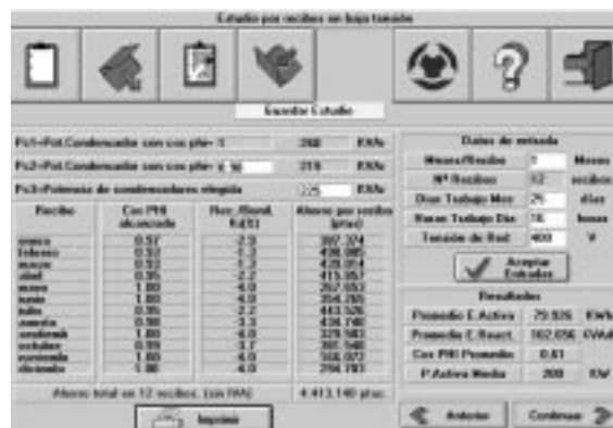
► Fig. 1.4.2-3. Pantalla del programa Cálculo CYDESA donde se calcula la potencia de condensadores para alcanzar el \cos \phi medio deseado. Al mismo tiempo se muestra mes a mes el recargo o bonificación así como el ahorro obtenido de acuerdo con los precios de la tarifa previamente elegida.
